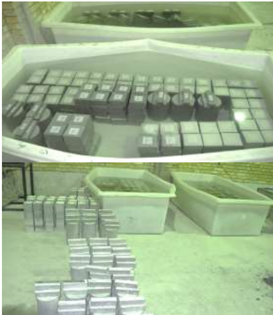
شکل ۳: عمل‌آوری نمونه‌های بتنی در شرایط محیط غرقاب و خشک
