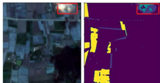
شکل ۳: میزان تاثیر پوشش ابری در بخش‌بندی (مستطیل راست بالا نشان‌دهنده ی ابر است)
