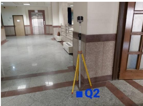
شکل ۵: استقرار بر روی نقاط عکس برداری به منظور تعیین دقت موقعیت یابی Fig. 5: Placement on the photogrammetric points to determine the positioning accuracy
