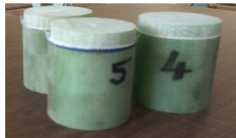
Fig. 1. GFRP composite specimen.
