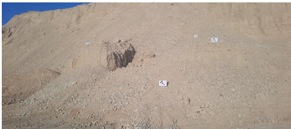
شکل ۴: نحوه توزیع نشانگرهای کددار Fig. 4: Distribution Pattern of Coded Targets
