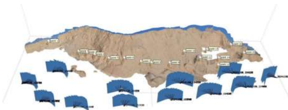
شکل ۸: مدل سه‌بعدی تولید شده و موقعیت ایستگاه‌های تصویربرداری Fig. 8: The produced 3D model and the positions of the imaging stations.
