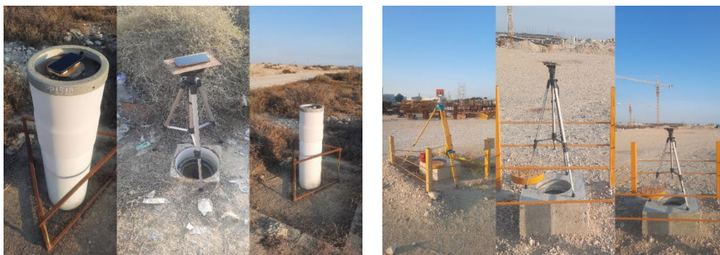
شکل ۳: تصاویر نقاط شبکه ژئودزی و نحوه استقرار تلفن هوشمند برای جمع‌آوری داده‌های GNSS Fig. 3: Images of Geodetic Network Points and the Setup of the Smartphone for GNSS Data Collection
