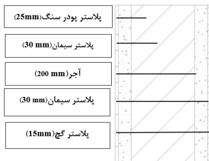
شکل ۷- لایه بندی دیوار خارجی Fig.7- External wall layering
