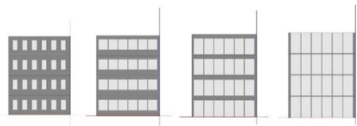
شکل 2 - نسبت پنجره به دیوار در حالات مختلف
